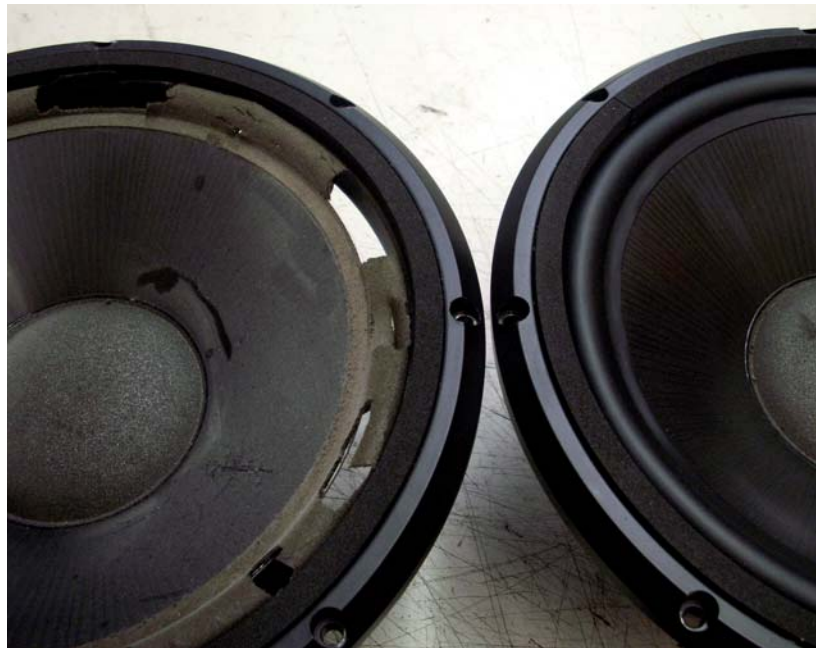
Eine brüchige Schaumstoffsicke (links) wurde durch eine dauerhafte Gummisicke (im Foto rechts) aus dem Klangmeister-Bestand ersetzt.
