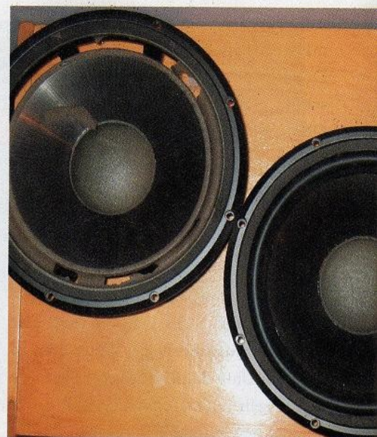
Aus Alt mach Neu: Lautsprechersicken aus Schaumstoff zersetzen sich im Laufe der Zeit. Ein Kappa 9-A-Basschassis vor und nach dem Eingriff des Klangmeisters.
